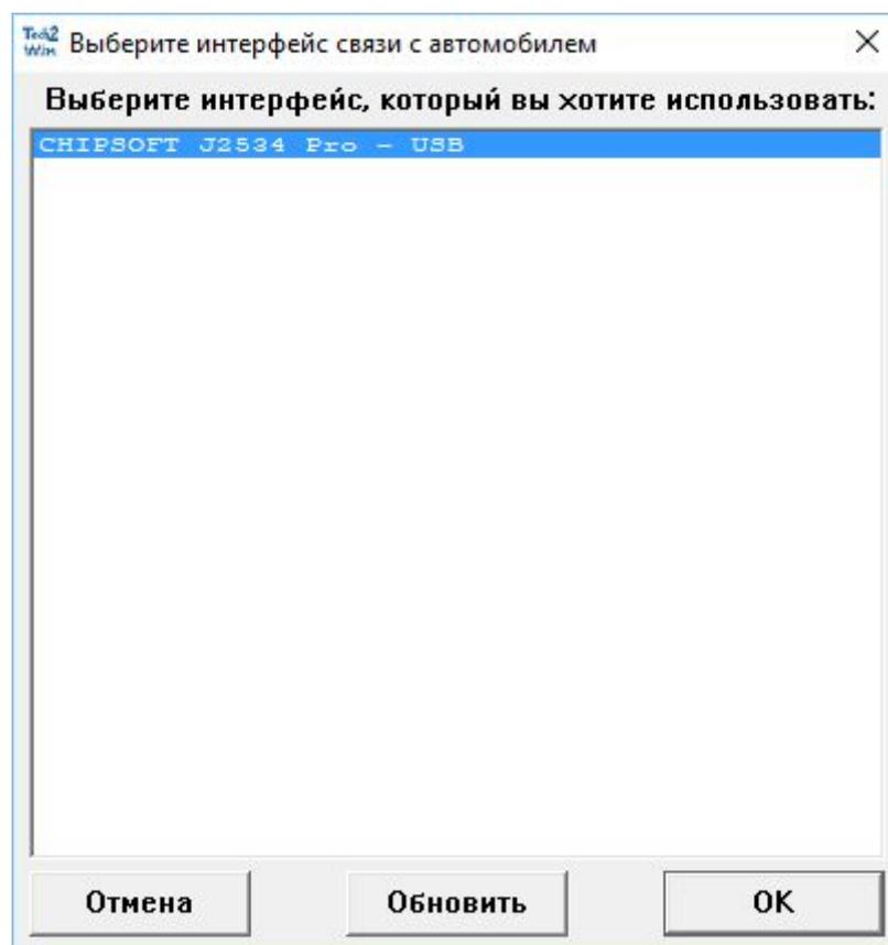
CHIPSOFT J2534 Pro не может одновременно использовать SW CAN на пине 1 и CAN на пинах 3 - 11. Некоторые модули Tech2Win (например, Opel) запрашивают для своей работы именно такую конфигурацию. Чтобы разрешить эту проблему, необходимо отключить один из каналов CAN. Таким образом можно протестировать сначала
